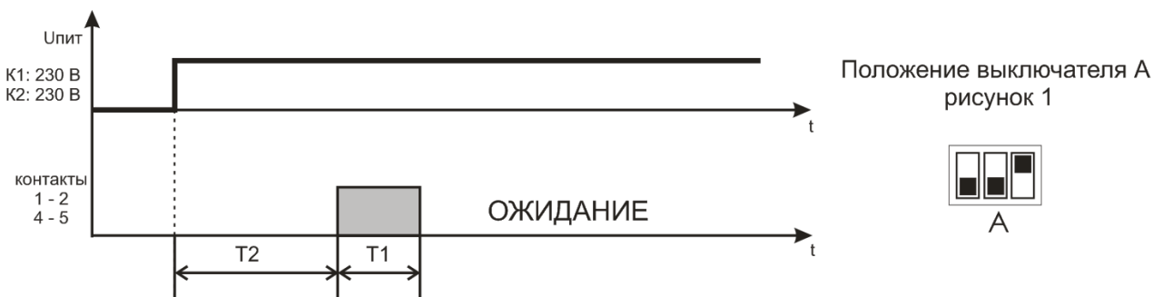
Рисунок 3 – Алгоритм работы реле “Импульсный 1”
