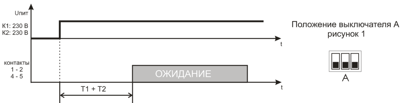
Рисунок 2 – Алгоритм работы реле “Задержка на включение”
