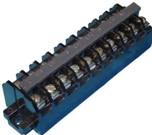
Блоки зажимов предназначены для присоединения и ответвления медных и алюминиевых проводников в электрических цепях переменного тока напряжением от 6 до 660 В частоты 50 Гц и 60 Гц и постоянного тока напряжением от 6 до 440 В и применяются как комплектующие изделия в стационарных установках.
