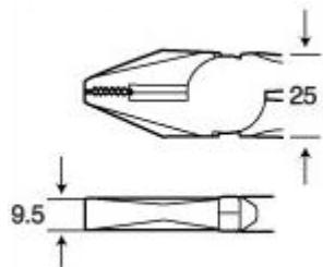
Резка мягкой стальной проволоки диаметром до 2.2 мм.
