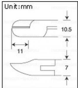
Мини кусачки с дополнительно закаленными режущими кромками из углеродистой стали
